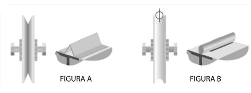
**Paso 3:** Verifique si la hoja del portón no traba en la carrera de apertura y cierre. El riel del portón debe ser perfectamente rectilíneo y nivelado. Retire periódicamente toda suciedad o elementos que comprometan el deslizamiento de las poleas por toda su extensión, como muestra la figura a continuación.
